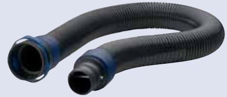
3M™ Versaflo™ BT-30 Solunum Tüpü Çeşitli kullanıcılara uyum sağlaması ve takılma ve tökezleme riskini azaltması için, kendinden ayarlı uzunluk Malzeme: Poliüretan Uzunluk: 525 - 850mm
